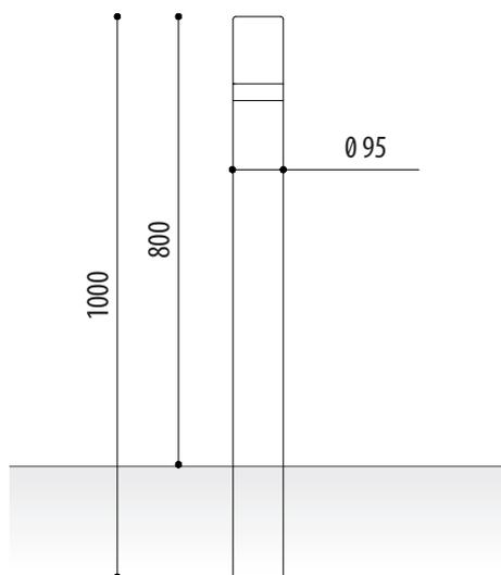
**Pilona modelo Barcelona** construida con tubo de hierro de diámetro  $\varnothing$  95. Altura total 1000 mm. Con anillo de acero inoxidable en la parte superior. Cabeza con cantos redondeados evitando posibles daños a personas.
